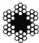
Cabluri din oțel normale 6x7+FC conform SR EN 12385-4
