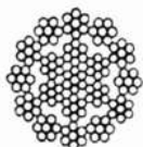
Cabluri din oțel antigiratorii 19x7 conform SR EN 12385-4
