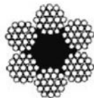
Cabluri din oțel normale 6x19+FC conform SR EN 12385-4
